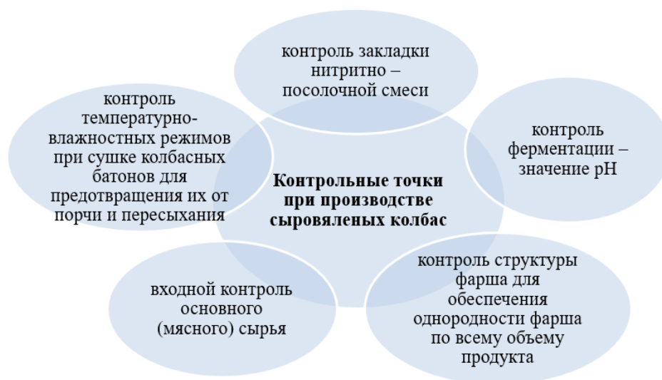
Рис. 5. Контрольные точки при производстве сыровяленых колбас
