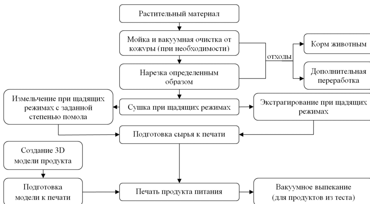
Рис. 1. Блок-схема производства продуктов функционального назначения с применением пищевого 3D-принтера
